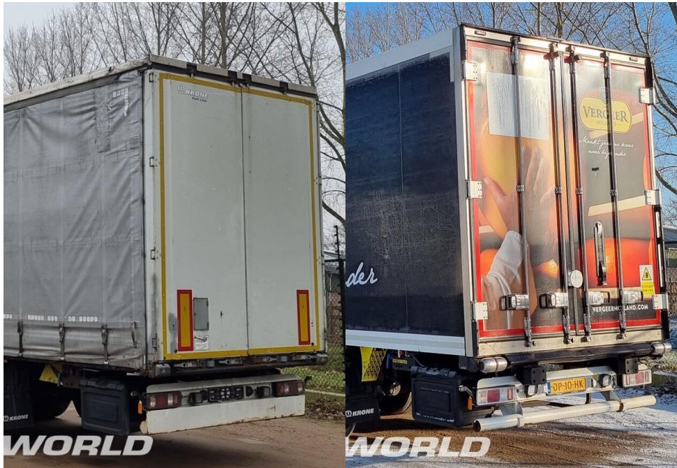
Figur 36 Lastbiltrailers med svängdörrar
