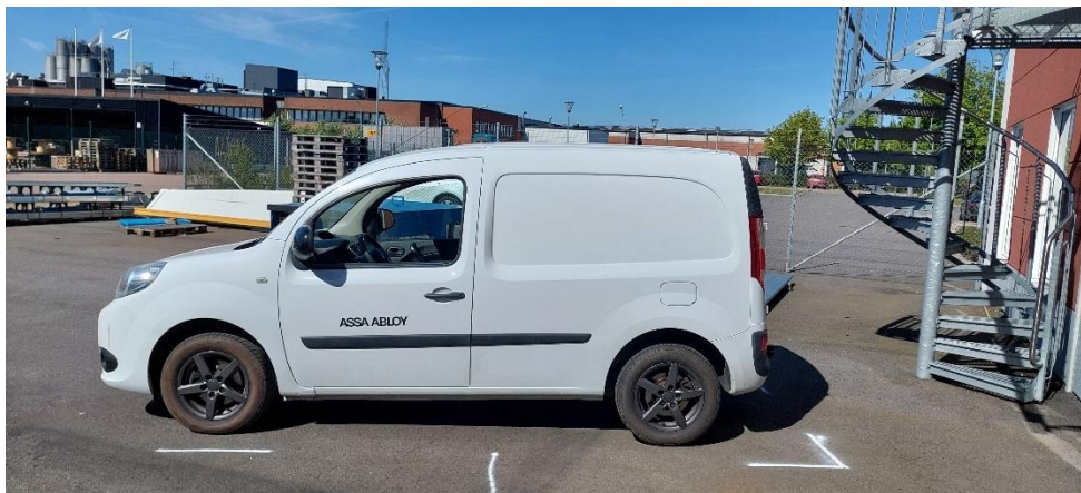
Figur 19 Vy från sidan av upplägget för kamera testet. Parkeringsområdet är markerad i vit runt lastbilen och kameran är monterad på undersidan av andravåningen av trappan.
