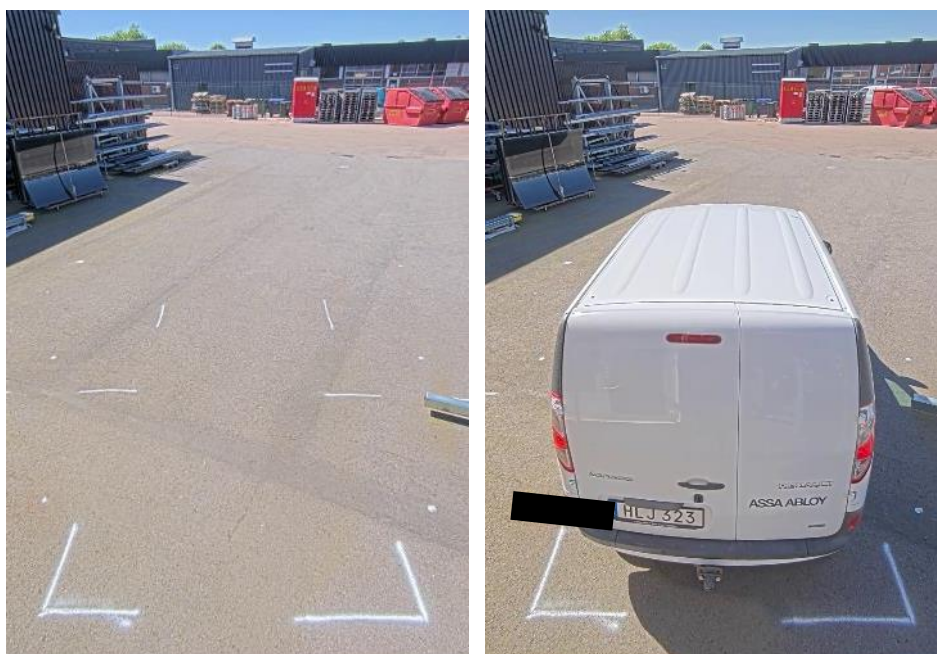
Figur 20 Parkeringsområdet utan och med lastbilen parkerad. De två horisontella linjerna representerar början av exkluderingszonen för personal.
